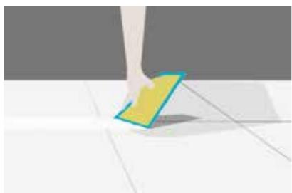
Após a aplicação, rejunte o pavimento. Respeitar o tempo de secagem indicado pelo fornecedor de colas para tráfego leve.
