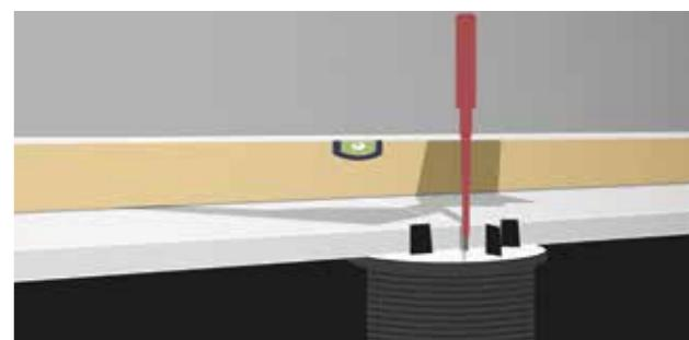
Com a ajuda da chave de afinação é possível obter uma superfície plana, estável e com a devida inclinação para um melhor isolamento de água.
