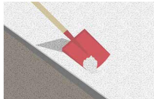
Forme um substrato estável e uniforme com a gravilha de 4-8mm.
