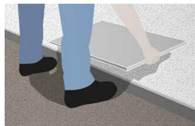
Posicione a placa cerâmica e compacte os bordos de modo a nivelá-los com o substrato. Sugermos uma junta de 4mm para garantir um bom escoamento de água.
