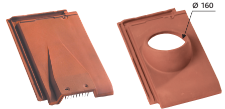
Tuile de ventilation HP 10 Huguenot (section avec grille = 50 cm 2 ) Réf. 205.20
